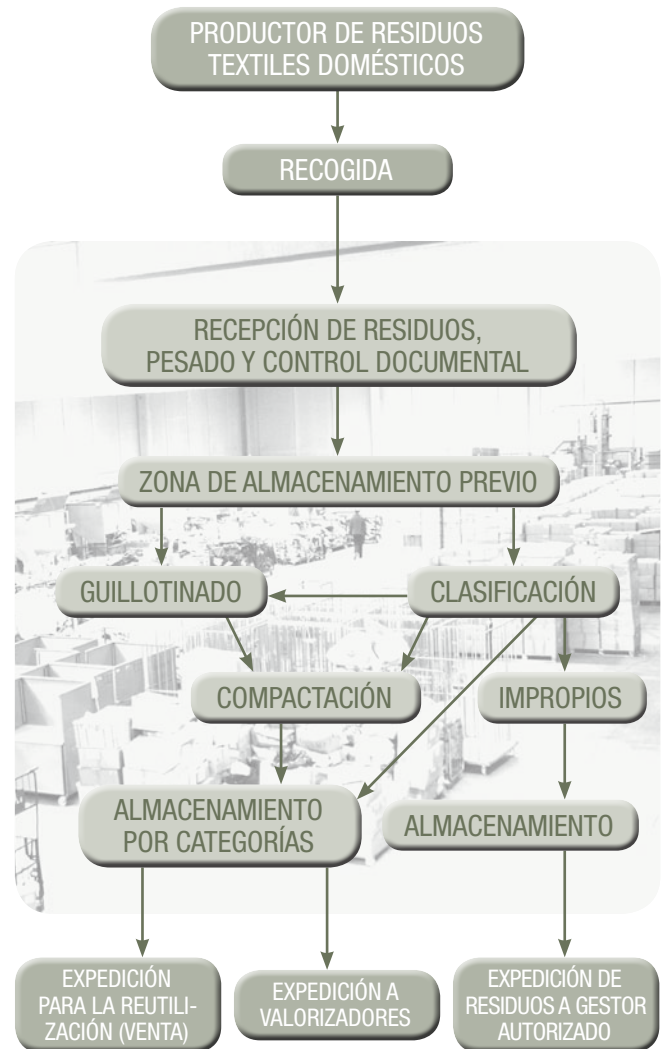
Figura 8. Esquema de los procesos de preparación para la reutilización.
