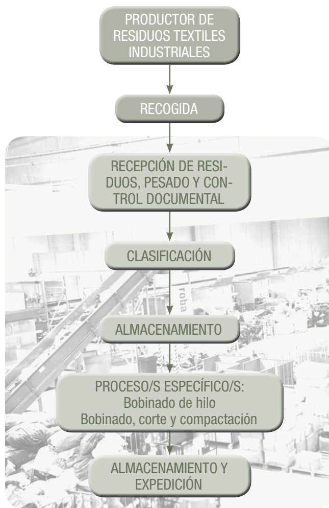
Figura 9. Esquema de los procesos de valorización de bobinas de hilo y restos de tejido textil.
